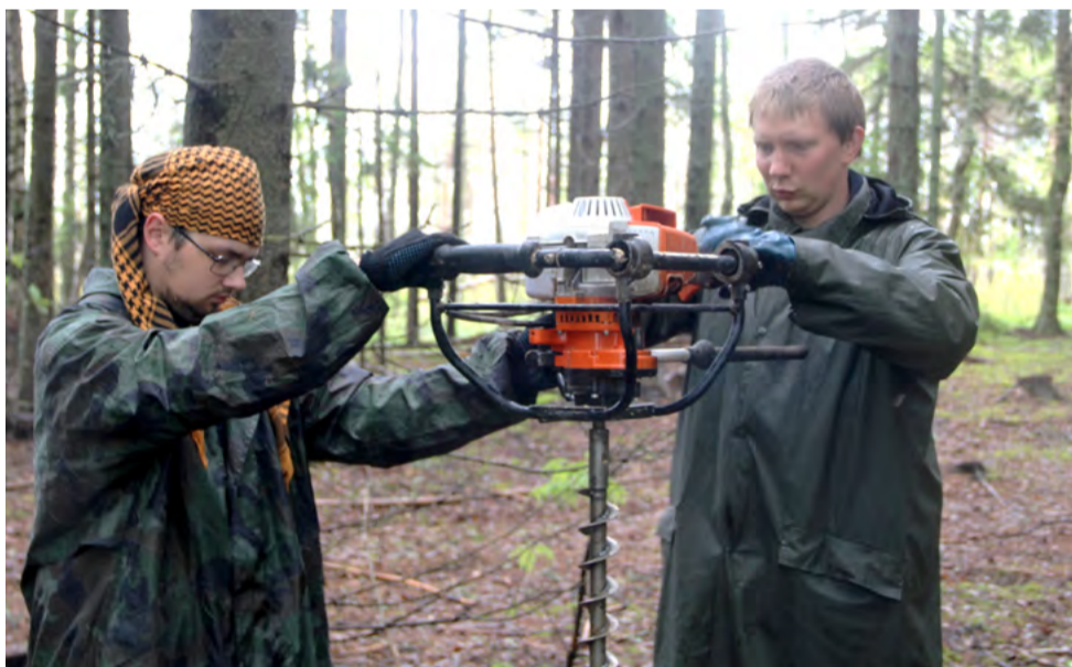
Использование мотобура для проникновения на глубину 9 метров
